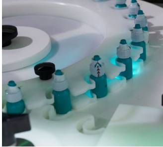
Markalama sırasında pozitif şişe kontrolü için yıldız tekerlek taşıması
