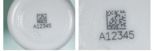
HDPE şişe üzerinde yüksek kontrastlı UV lazer markalaması
